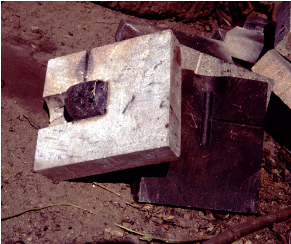
Abbildung 2: Gussform aus Speckstein für einen Zylinder, mit seitlicher Öffnung für die Temperatursonde.
