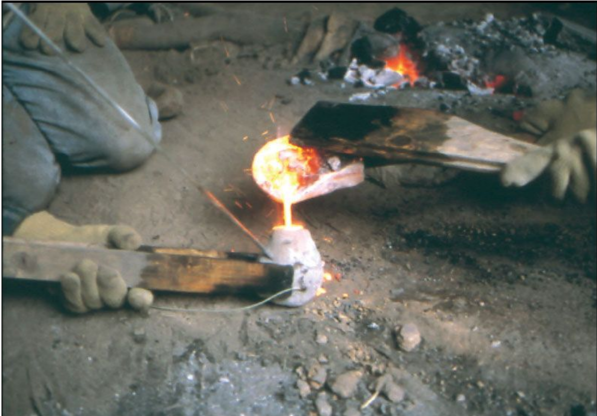
Abbildung 1: Der Guss in eine Tonform. Kurz vor, während und direkt nach dem Guss wurden mit zwei Thermosonden die Temperatur der Gussform und des eben gegossenen Bronzeobjektes gemessen.
